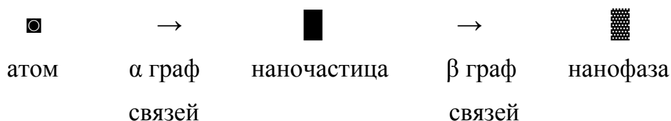
Рис. 3.1. Схема топологического строения наноматериалов. Включает в себя три уровня элементов: атом, наночастица, нанофаза и два уровня сил связей: \alpha (когезия), \beta (адгезия).
